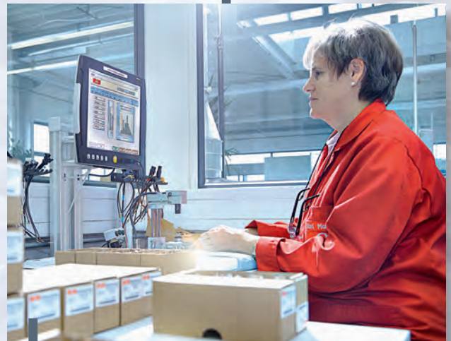
Vollautomatische Schaltungseinstellung mit EDV-gestützter Dokumentation der Messwerte.
