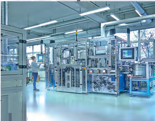
Montage und Prüfung von Druckschaltern an teil- und vollautomatisierten Anlagen.
