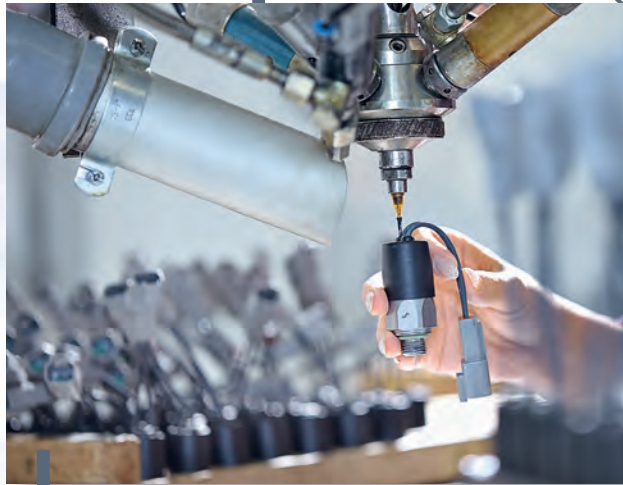
Vergießanlage für kundenspezifisch konfektionierte Druckschalter für höchste Ansprüche an die IP-Schutzart.
